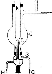
Glasrohr G von außen gekühlt werden, weiß es sonst alsbald zu heiß wird und erweicht oder springt. Das T-Rohr am oberen Ende von G dient zum Abzweigen beliebiger Teile des austretenden Gases für die einzelnen Versuche.
